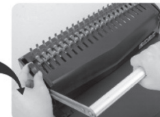
(Рис 5.) Вставьте и откройте пружинку. Надавите на фиксатор гребёнки, чтобы зафиксировать её в нужном положении
