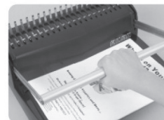
(Рис 4.) Опустите ручку вниз до упора полностью пробив стопу бумаги
