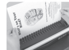
(Рис 6.) Поместите перфорированную бумажную стопу в открытую пружинку
